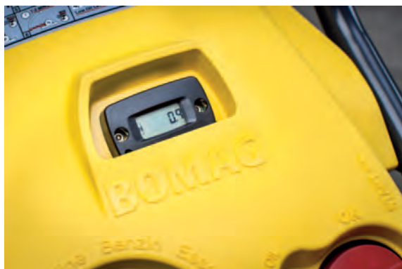
Contador de horas y de régimen con indicador de servicio (de serie: BT 60 y BT 65, opcional: BVT 65).
