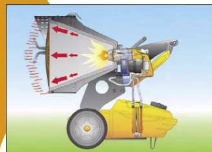
XL9. Esquema de funcionamiento: Detalle de la Cámara de Combustión, Quemador, Llama de combustión.
