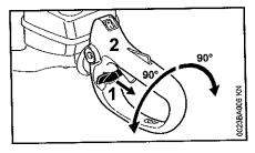
Para manejar cómodamente el cortasetos en cualesquiera técnicas de trabajo, la empuñadura se puede girar 90° hacia la izquierda y la derecha.
