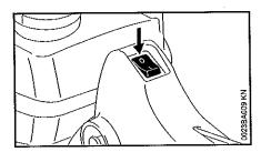
Accionar el pulsador de parada hacia 0 – tras soltarlo, el pulsador pasa a la posición de funcionamiento I
