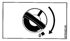
Mantener el cierre del depósito presionado y girarlo en sentido horario hasta que encastre
