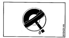
Entonces quedan alineadas entre sí las marcas en el cierre del depósito y en el depósito de combustible
