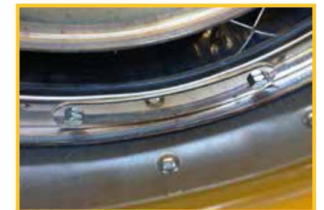
Dispone de tapas en el intercambiador de la cámara de combustión para su fácil limpieza
