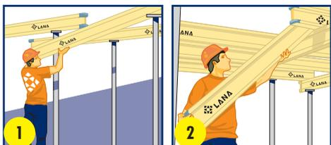
Montar puntales y vigas primarias, utilizando trípodes y cabezales "U" en los puntales para mayor seguridad.
