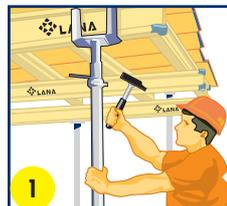
Bajar vigas y tableros mediante cabezales basculantes y retirar puntales intermedios.
