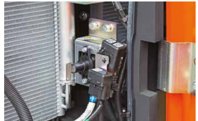
El interruptor de desconexión de batería permite realizar las tareas de mantenimiento de forma segura.
