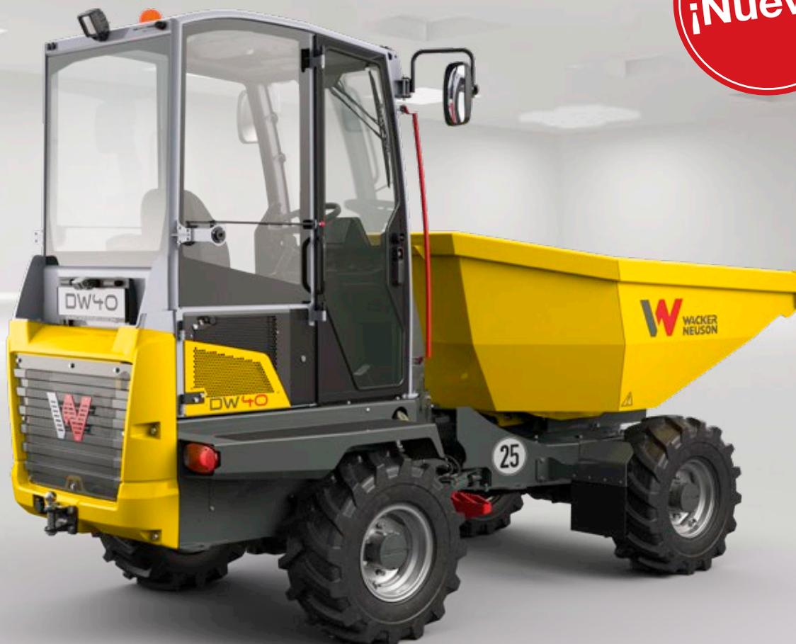
**La barra antivuelco abatible con amortiguadores de gas** permite atravesar pasos de muy baja altura
